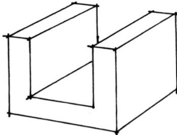
Die EBN U-Schale findet Verwendung für Ringbalken und Stürze in Mauerwerkswänden und wird in allen gängigen Wandstärken aus natürlichem Blähton und Zement produziert.
